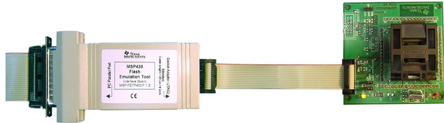
**Bild 36** Das Flasch Emulation Tool (FET, links) wird zwischen Paralleler- (PC) und JTAG- (Mikrocontroller) Schnittstelle gehängt. Es erlaubt das "In system programming" (ISP). Der Mikrocontroller sitzt im Sockel (geschlossen, rechts).
