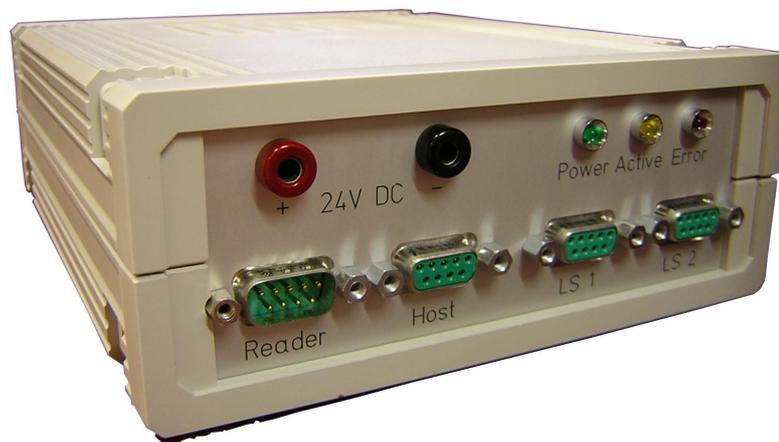
**Bild 47** Der Applikationskontroller besitzt zwei serielle Schnittstellen (RS-232) und zwei Eingänge für Lichtschranke 1 und 2. Drei Leuchtdioden signalisieren den momentanen Zustand.
