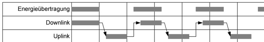
**Bild 11** Darstellung der zeitlichen Abläufe bei Voll-, Halbduplex- und sequentiellen Systemen. Die Datenübertragung vom Lesegerät zum Transponder wird in der Abbildung als downlink, die Datenübertragung vom Transponder zum Lesegerät als uplink bezeichnet.
