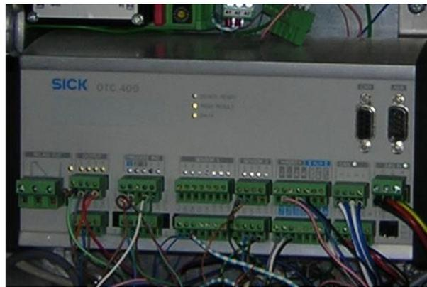
**Bild 7** Der OTC (Omni Tracking Controller) von der Firma SICK AG. Die gelesenen Barcode-Informationen werden durch ihn an einen Host übertragen.
