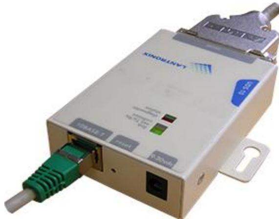
**Bild 33** Die Bridge "Lantronix UDS-10" konvertiert RS-232 auf Ethernet und umgekehrt.
